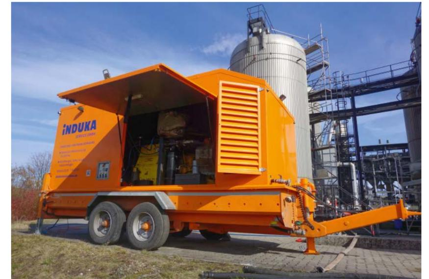
Moderne Technik: Höchstdruck-Aggregat mit 3000 bar für die schwierigsten Fälle der Industriereinigung
