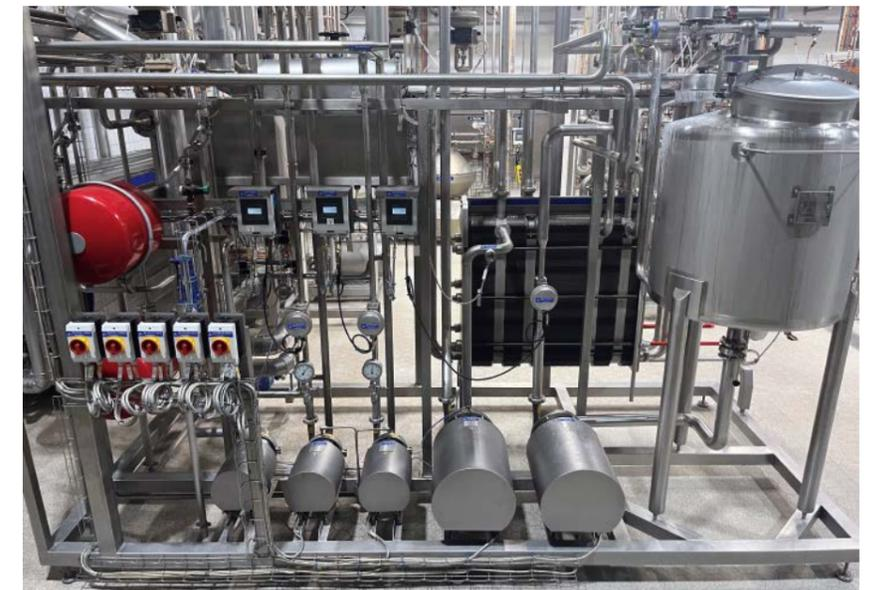
Eine fertig montierte Erhitzeranlage zur Milchverarbeitung
